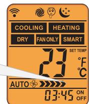
☑ **Bei "Lüfter Nur" Modus sind nur "Auto" nicht verfügbar. Bei "Trocken" Modus, die Lüfterdrehzahl wird bei "AUTO" automatisch festgelegt, "Lüfter" Taste ist in diesem Fall unwirksam. Einige Modelle, wie z. B. handelsübliche Klimaanlage, haben nur den dritten Gang.**
