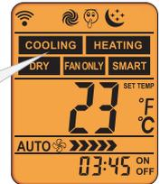
☑ **Heizung Modus ist nicht zur Kühlung nur Klimaanlage zur Verfügung.**
